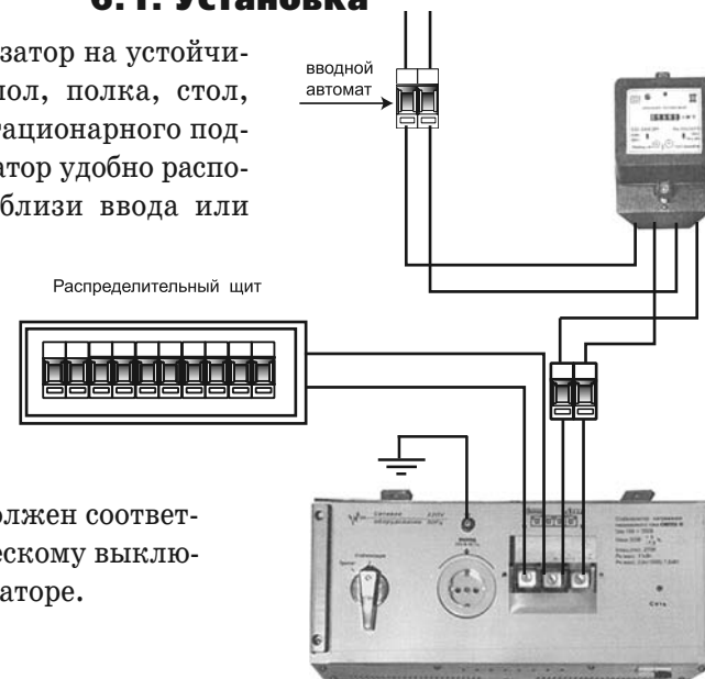
Рис. 10. Схема установки стабилизатора
