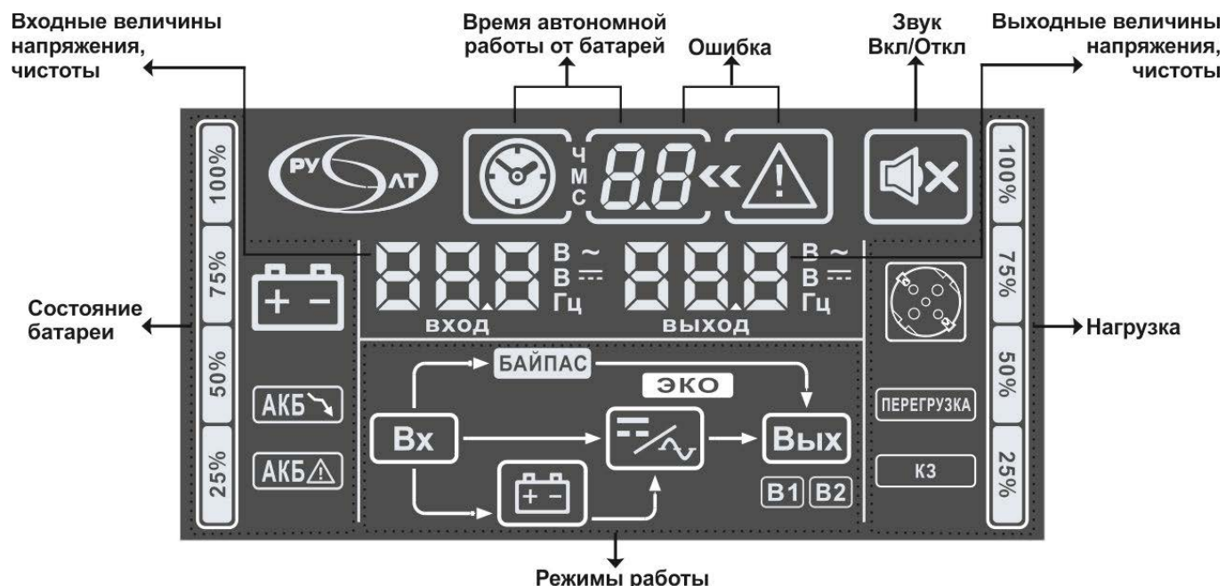
Рисунок 3. Экран ЖК-дисплея ИБП.
